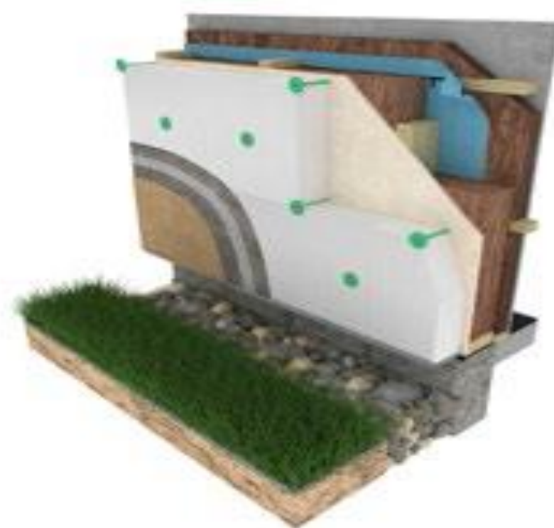
Difuzně uzavřená konstrukce s EPS
