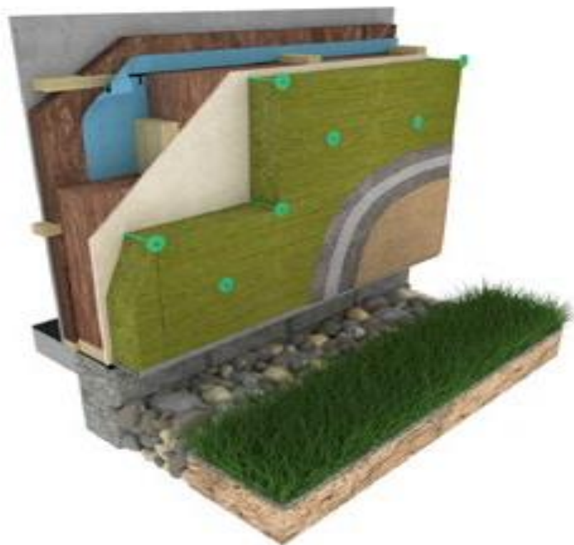
Difuzně otevřená konstrukce s minerální vlnou
